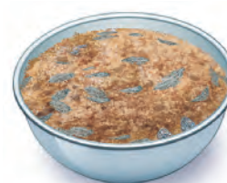
Mistura de palha de aço e areia.
